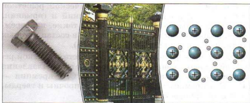
Рис. 77. Металлическая кристаллическая решётка (железо)
