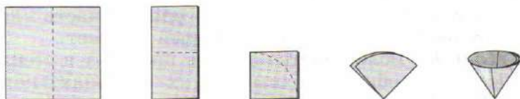
Рис. 121. Последовательность изготовления бумажного фильтра
