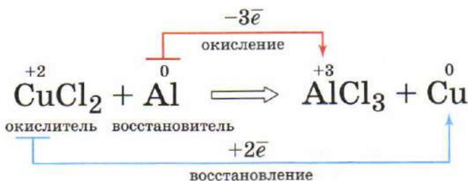
Рис. 146. Схема окислительно-восстановительной реакции
