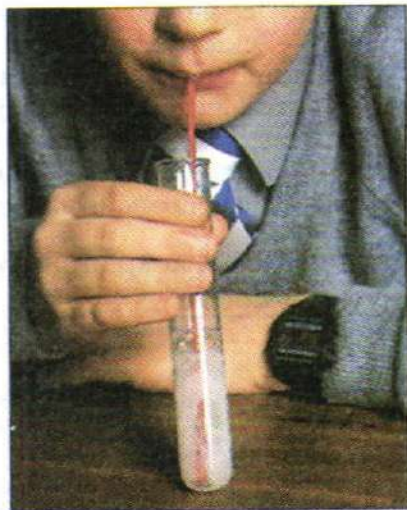
Рис. 61. Качественная реакция на углекислый газ
