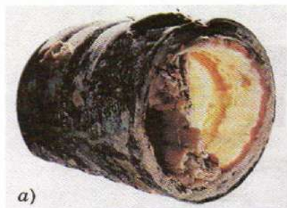
Рис. 80. Накипь: а — на стенках труб; б — на спирали электрического чайника
