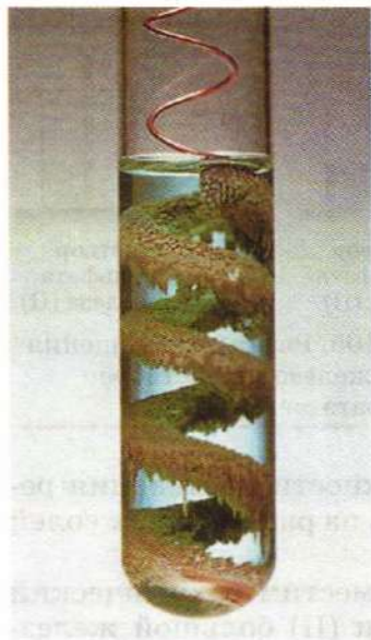
Рис. 107. Кристаллы серебра, выделившиеся на медной проволоке в результате реакции замещения меди в растворе нитрата серебра
