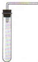
Рис. 123. Прибор для получения газов
