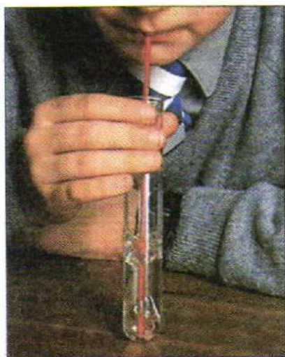
Рис. 61. Качественная реакция на углекислый газ
